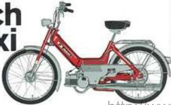
Låt inte lura dig av namnet — Maxi är Puchs specialbyggda minimoped, på bara 35 kg! Den är helautomatisk. Ingen växelpedal och ingen koppling. Vrid bara på gasen, så växlar Maxi själv. Puch Maxi väger bara hälften mot en mopedskoter. Andå är den ovanligt stabilt byggd. Brede, säkra däck. Seden är den mjukaste vi gjort. Och ramen är extra låg, så att flickor mycket väl kan köra Maxi — även med kjol! Och det kanske allra bästa — Puch Maxi kostar under 1.000 kr!
