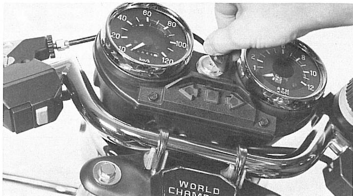
Tændingsnøglen sættes ned i tændingslåsen. Første hak til højre = tændingstilslutning. Andet hak til højre = lys. Motoren standses ved at dreje nøglen tilbage til 0-stilling.
