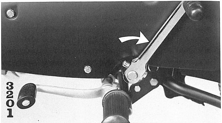
Gearpedalen viser placeringen af de tre gear og det låsede frigear mellem 1. og 2. gear. Kickstarteren trædes bagud.
