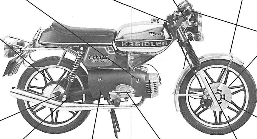
Bremsevæske i beholder til skivebremse
