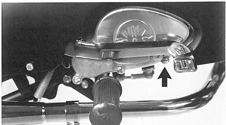
Fodbremsepedalen til baghjulsbremsen. Pilen viser skruen til oliekontrol på gearnissen.
